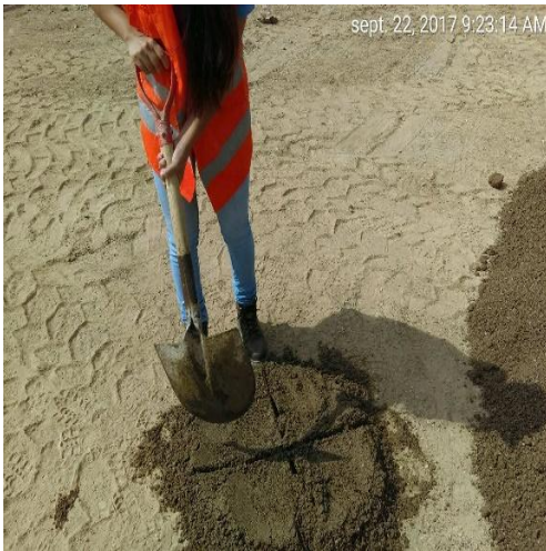
Figura 46. Cuarteo del agregado grueso
