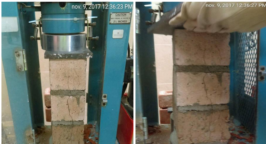
Figura 65. Fallas de pilas de unidades de concreto
