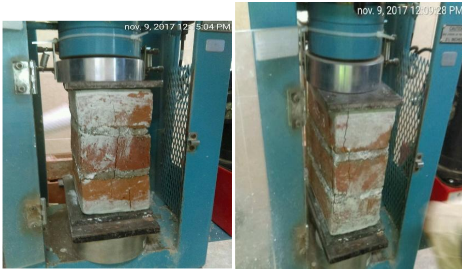
Figura 64. Fallas de pilas de unidades de arcilla
