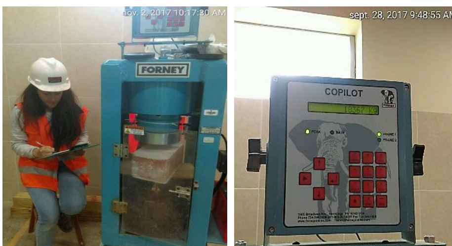
Figura 54. Toma de datos de ensayo de resistencia a compresión
