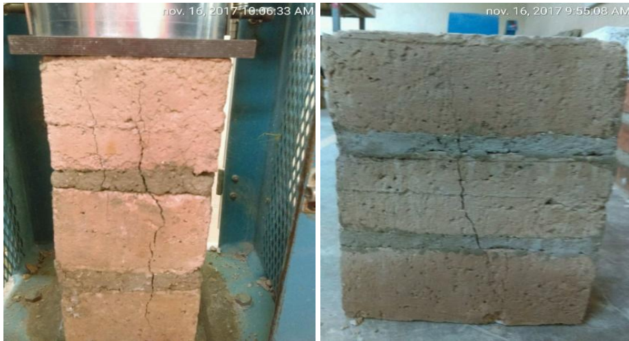
Figura 70. Fallas de pilas de unidades de concreto
