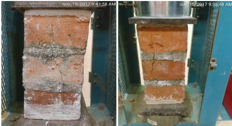
Figura 67. Fallas de pilas de unidades de arcilla
