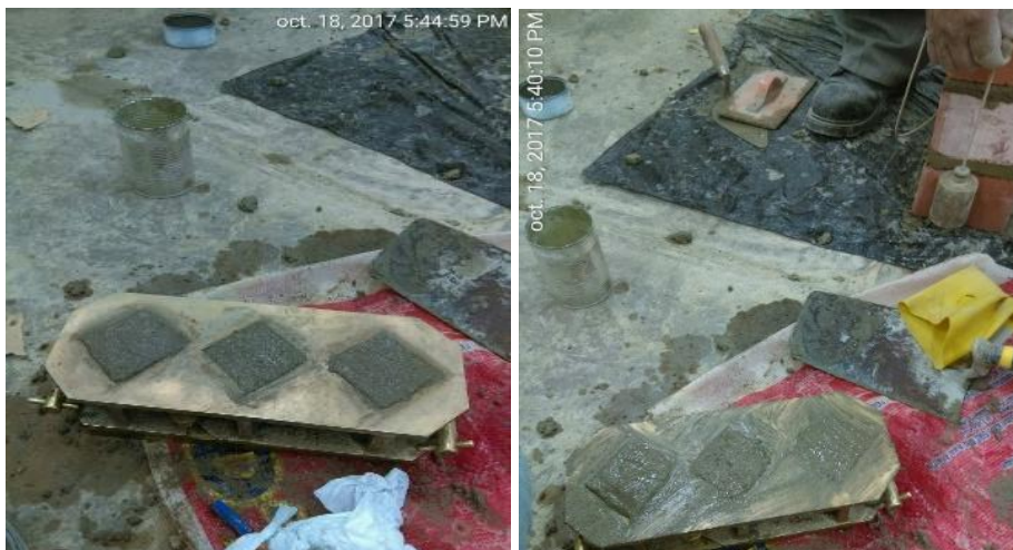
Figura 60. Colocación de mezcla de mortero con cal en el molde
