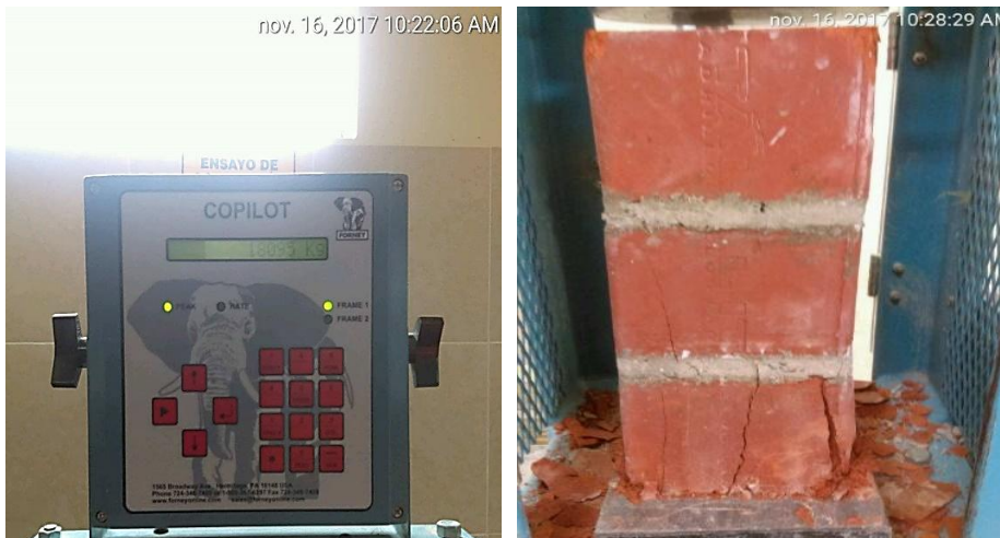
Figura 71. Fallas de pilas de arcilla industrial
