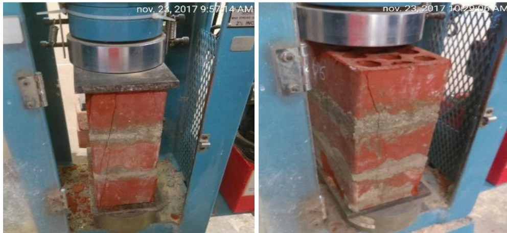
Figura 73. Fallas de pilas de arcilla industrial
