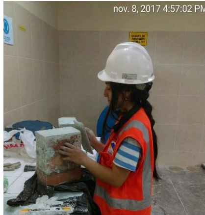
Figura 34. Refrentado de pilas de unidades de albañilería
