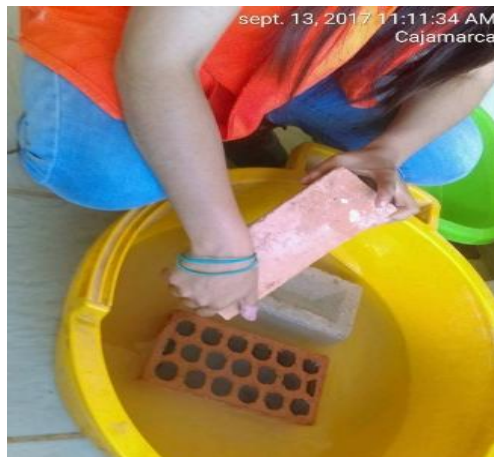
Figura 28. Sumergido de unidades de albañilería
