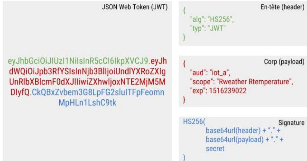
Figure 7 : JSON Web Token créé avec la structure JWS
