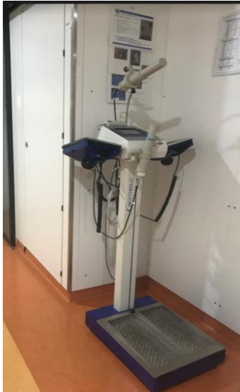
Figure 29 Moniteur de contamination de surface pieds mains des HUG
