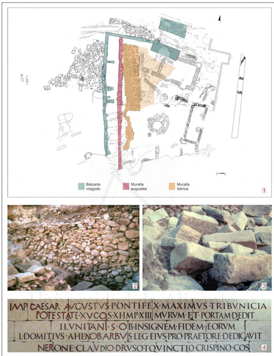
Fig. 5. 1. Planimetría de las diversas estructuras defensivas del acceso a la ciudad (Abad et al. 2012b, 361, fig.11); 2. Muralla ataludada de época Ibérica. 3. Derrumbe de sillares romanos reutilizados en el baluarte visigodo; 4. Reconstrucción de la inscripción de la muralla romana (Abad et al. 2012b, 353, fig.2).
