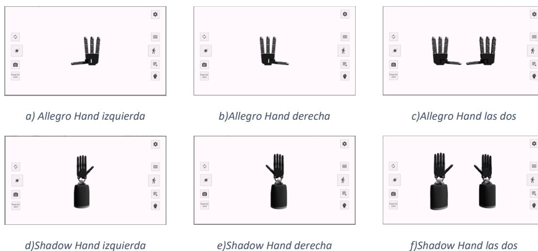
Figura 16: Carga de las manos usando el lector URDF a) Allegro Hand mano izquierda b) Allegro Hand mano derecha c) Allegro Hand las dos manos d) Shadow Hand izquierda e) Shadow hand derecha f) Shadow hand las dos manos 19
