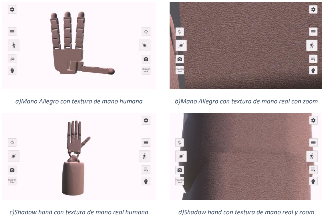
Figura 22: Carga de textura de mano real sobre las manos robóticas simuladas y zoom para apreciar las arrugas de la piel. a) Mano Allegro Hand b) Mano Allegro con zoom sobre uno de los dedos c) Shadow hand con textura de piel humana d) Shadow hand con textura de piel humana real y zoom sobre uno de los dedos 25
