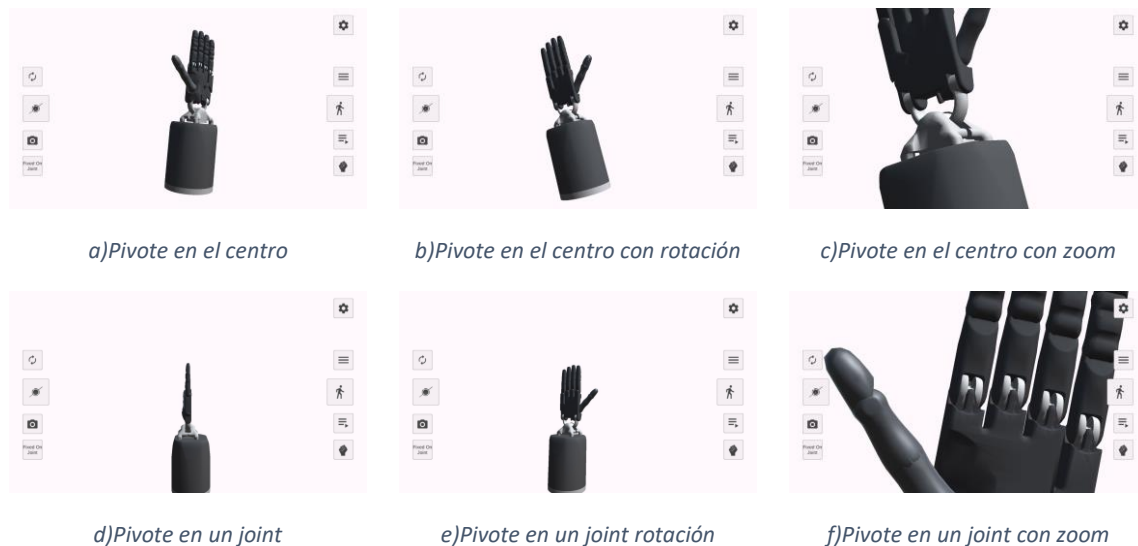
Figura 21: Rotación y zoom en la mano Shadow rotando y realizando zoom sobre el centro de las posiciones y sobre uno de los joints a)Pivote en el centro b)Pivote en el centro con rotación c)Pivote en el centro con zoom d)Pivote en una articulación e)Pivote en una articulación con rotación f) Pivote en una articulación con zoom. 24
