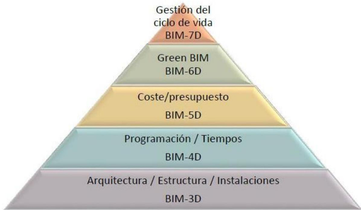
Figura 4 – Pirámide multidimensional BIM. Fuente: <http://jguillen07.blogspot.com.es/2015/11/niveles-de-madurez-y-dimensiones-del-bim.html> [Consulta: 25/10/2017] (Javier Guillén, 2015)
