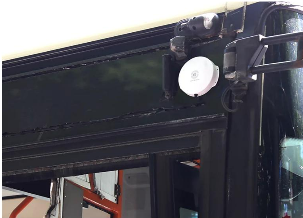
Figura 2.1.2: Un Beacon instalado en un autobus en [ExperienciaAutobusesBucarest].
