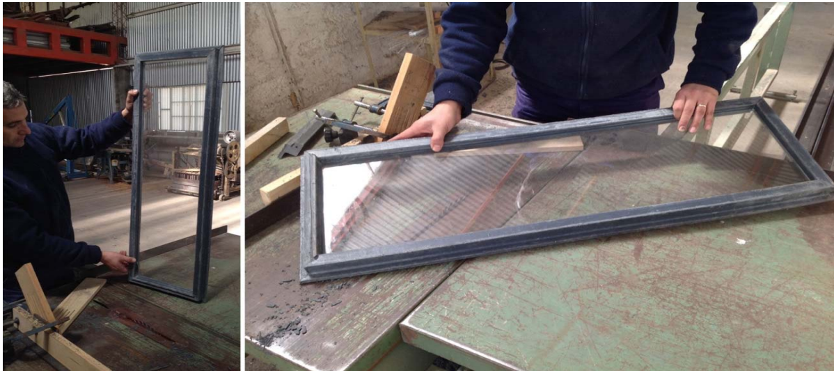
Fig 11. Prototipo de marco de ventana de perfilaría de plástico reciclado.
