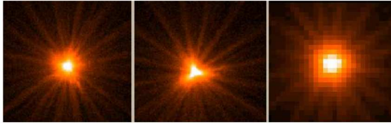
Figura 4.3. PSF on-axis de las cámaras MOS1, MOS2 y pn respectivamente en modo Small Window para MOS y Large Window para pn. Imagen tomada de XMM-Newton Users Handbook.
