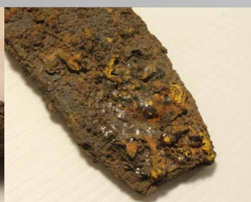
Ampollas frágiles y brillantes, gotas en superficie, coloración marrón. Focos localizados amarillos y naranjas.
