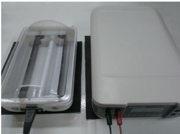
c) Electroforesis: La misma se realizó sobre cintas de acetato de celulosa (cellogel), sembrándose las muestras con aplicador semimicro (Chemar). Se corrieron 35m a 200V. El buffer utilizado fue de borato-acetato. (imagen 3)
