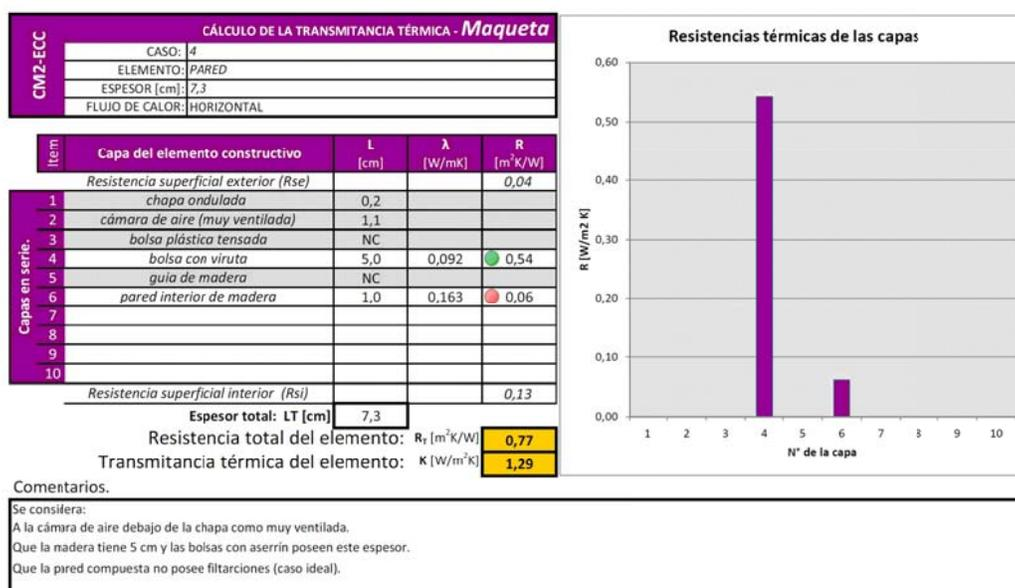
Fig. 3: Calculador elaborado para determinar la transmitancia térmica de los modelos.
