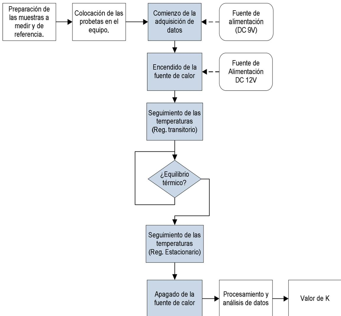
Fig. 3. Diseño funcional del equipo.
