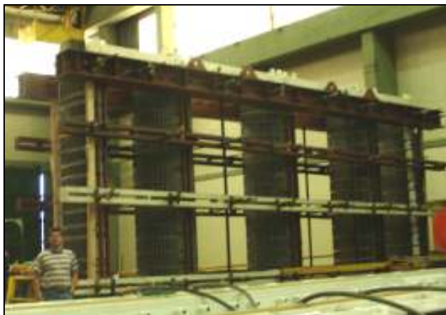
Foto 1 – Núcleo magnético de un transformador trifásico de potencia
