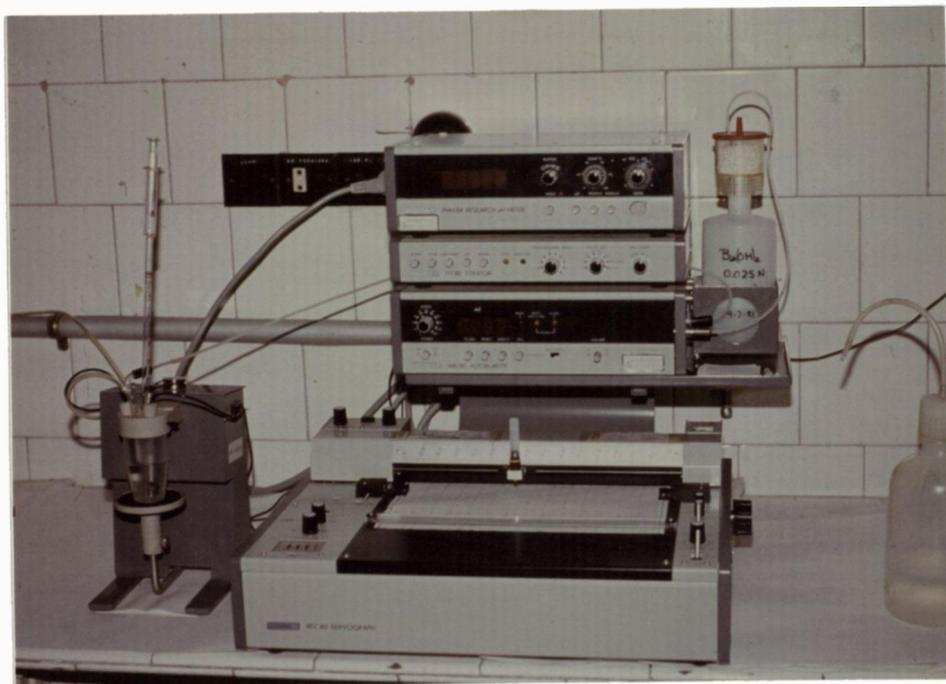
fotografía nº 3.- Conjunto de valoración automático RTS-822 de Radiometer, utilizado para la determinación de la CIC por el nuevo método potenciométrico.
