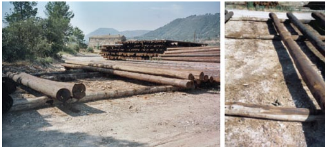
Figura 1 visión panorámica y detallada de los acopios de troncos tratados con creosota durante el proceso de secado
