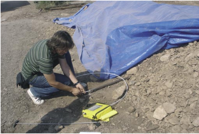
Figura 7 determinación de la concentración de oxígeno y dióxido de carbono en el sistema
