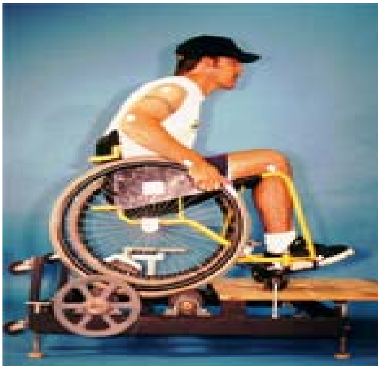
Ciclo ergómetro de silla de ruedas en tapiz rodante.
