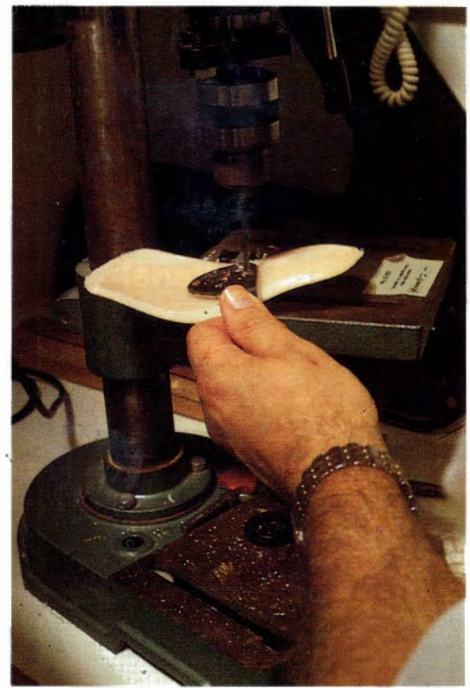
Fig. 15.- Aplicación de los remaches en el S.P. termoplástico.
