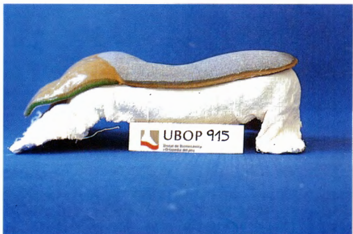
Fig. 22.- Aplicación del S.P. en el molde.
