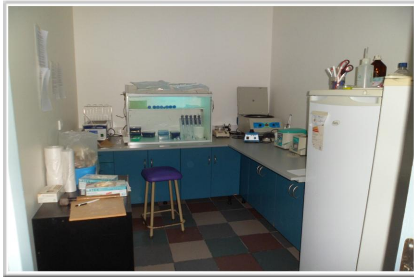
Figura 6.1. Laboratorio de ADN empleado. Cuenta con luz UV para todo el cuarto. Además, dentro de la campana de trabajo existe otra lámpara UV donde se irradia el material a utilizar.
