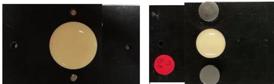
*Figura 11 - Espécime montado e fixado com gesso tipo IV às placas de Watanabe para realização do ensaio de resistência adesiva sob tensões de corte.*
