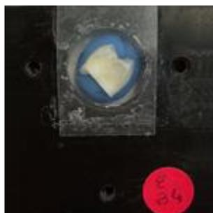
*Figura 9 - Face polida e plana do esmalte adaptada na placa do dispositivo de Watanabe através de película transparente de poliéster com orifício padronizado de 3 mm.*
