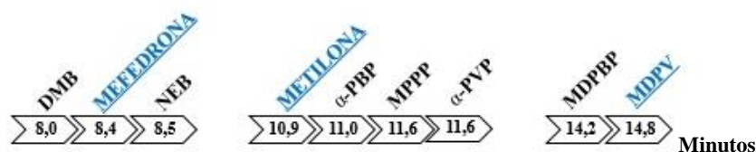
Figura 3.5 - Discriminação dos tempos de retenção (minutos) das 6 catinonas sintéticas selecionadas como possíveis interferentes para as substâncias em estudo, após análise por GC-FID.
