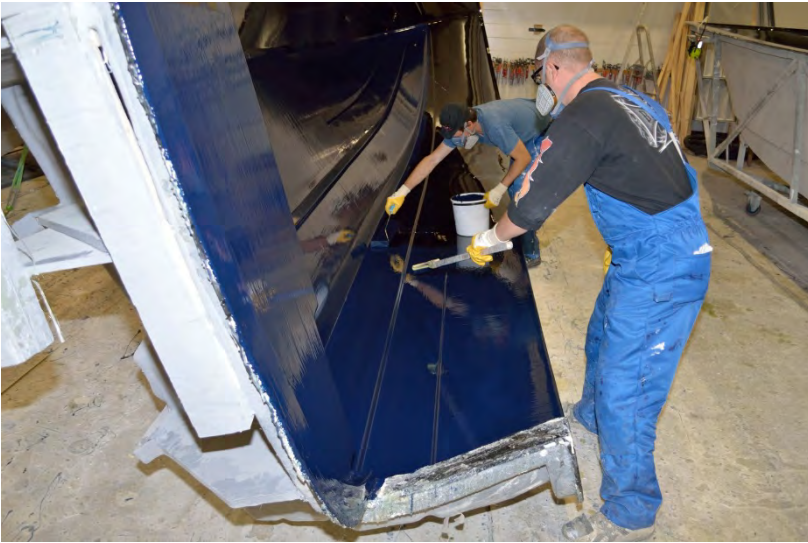
Kuva 10. Gelcoatien levittäminen runkoon telalla ja rullalla. Työntekijät käyttävät hengityksensuojaimina puolinaamareita, joissa on aktiivihilisuodatint.
