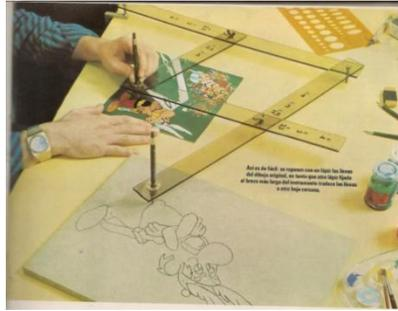
**Pantógrafo de dibujo<sup>5</sup>**
