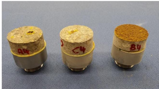
Abbildung 4.69: Abgezogene Stempel bei -10 °C
