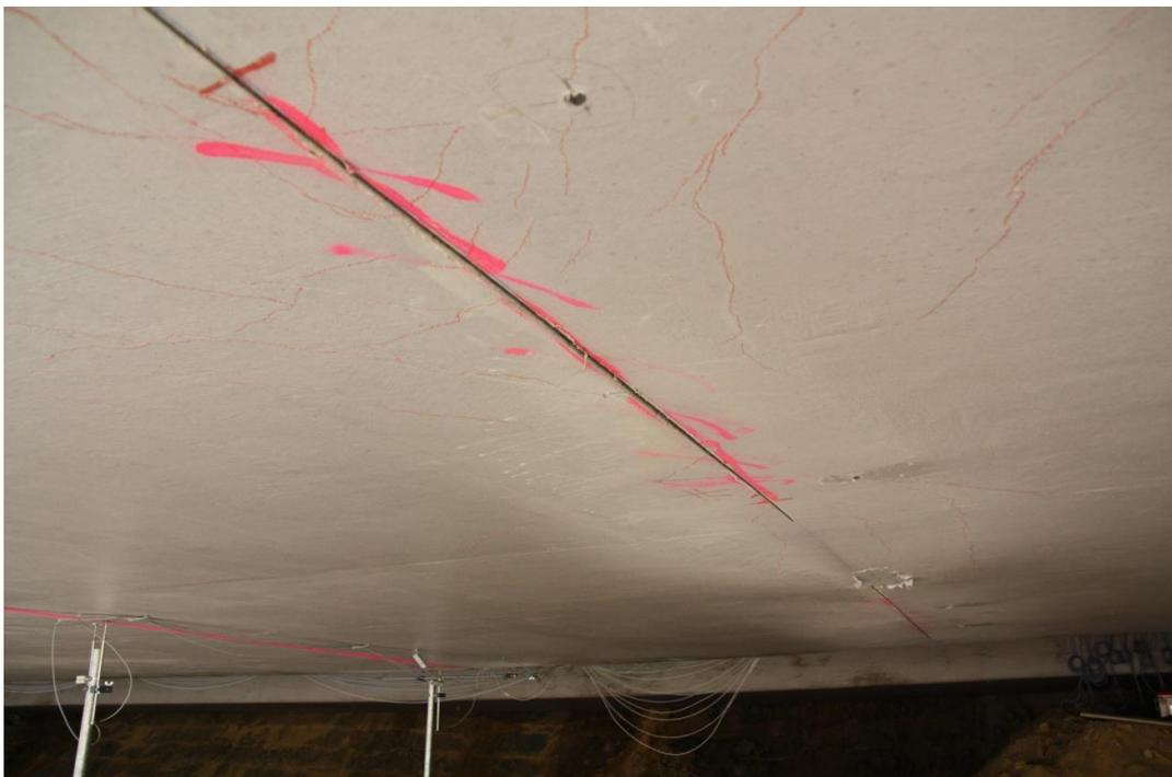
Abbildung 8.18: Schubrisse in der Bodenplatte an der Stelle  $x = 0.45 L$  nach dem Durchtrennen der unteren Spannglieder (Schädigungsstufe #1) [SCH-11]
