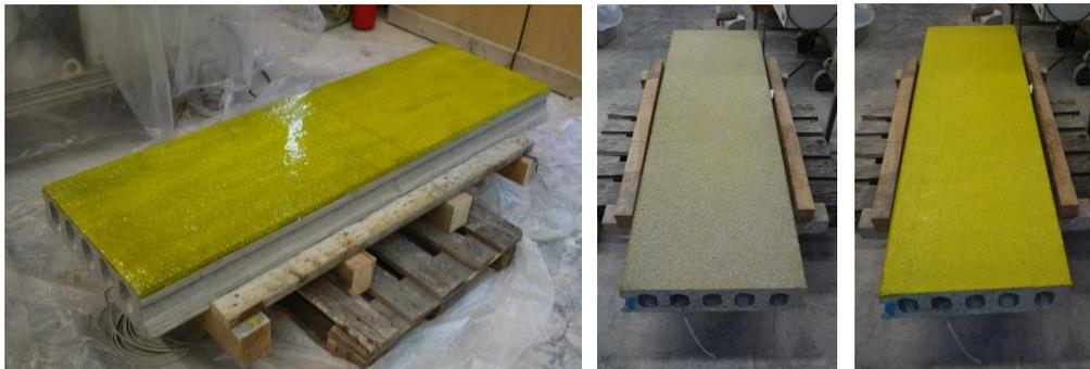
**Abbildung 4.3:** Zwischenschritte beim Herstellen der Grundierung und Versiegelung; links: Betonplatte mit aufgebrachtener Grundierung; Mitte: Betonplatte grundiert mit eingestreutem Sand; rechts: Betonplatte mit Versiegelung (zweite Reaktionsharzschicht)
