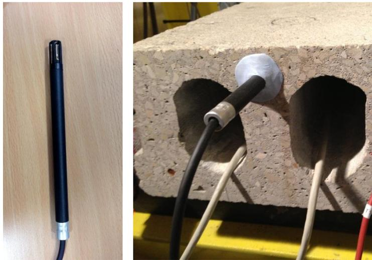
**Abbildung C.4:** Feuchtesonde - links: Feuchtesonde separat; rechts: Feuchtesonde im Bohrloch (mit Abdeckknete abgedichtet)
