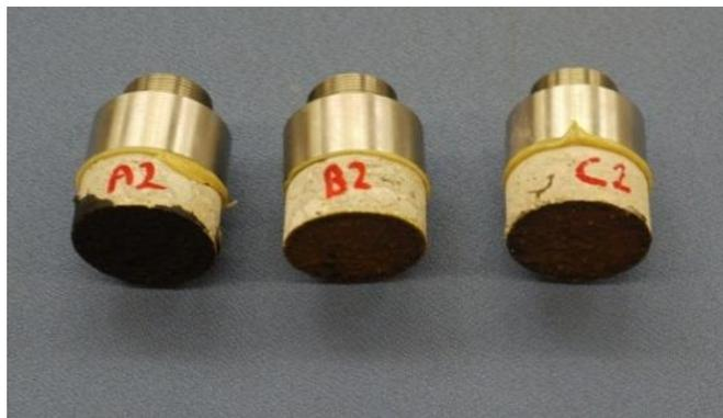
Abbildung 4.67: Abgezogene Stempel bei 10 °C
