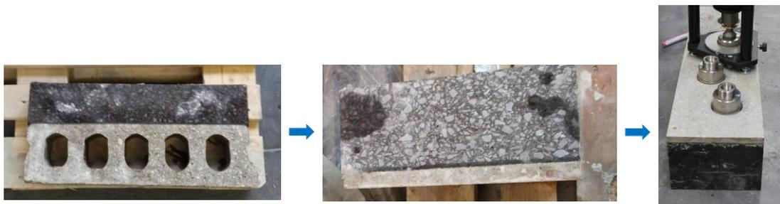
**Abbildung 4.61:** Entstehungsprozess der Probekörper a) bis e); links: Probekörper mit vollem Betonquerschnitt, Mitte: Probekörper nach Entfernung der Betonstege, rechts: Probekörper mit Ringnut und Stahlstempel
