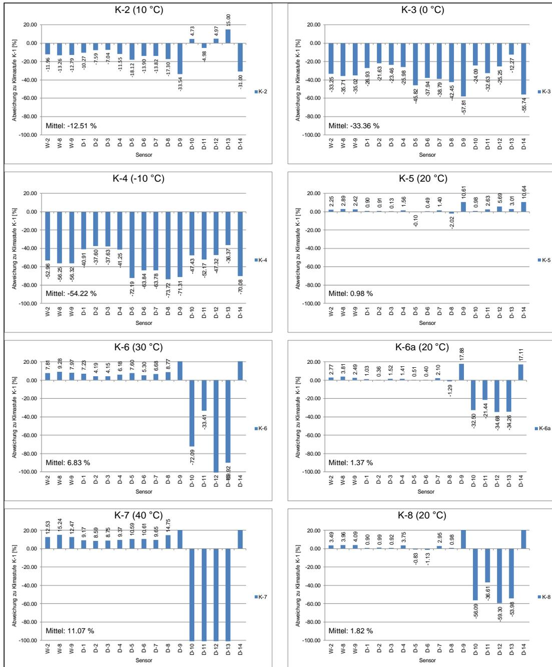
Abbildung C.36: Abweichung der Sensoren der Platte ACCS-1 mit Asphalt für die einzelnen Klimastufen, bezogen auf Klimastufe K-1 (Referenzmessung)<sup>17</sup>
