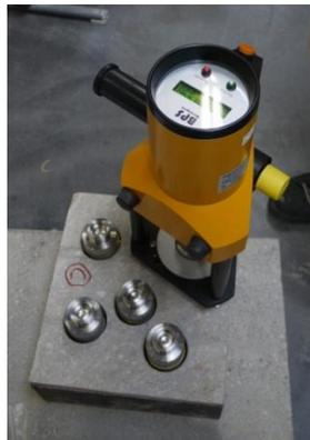
**Abbildung 4.62:** Prüfaufbau Oberflächenhaftzugfestigkeit / Abzugversuch für Beton-Asphalt-Elemente
