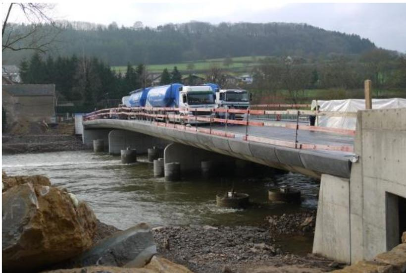
**Abbildung 5.18:** Brücke in Moestroff im Belastungsversuch mit LKWs als Versuchslast
