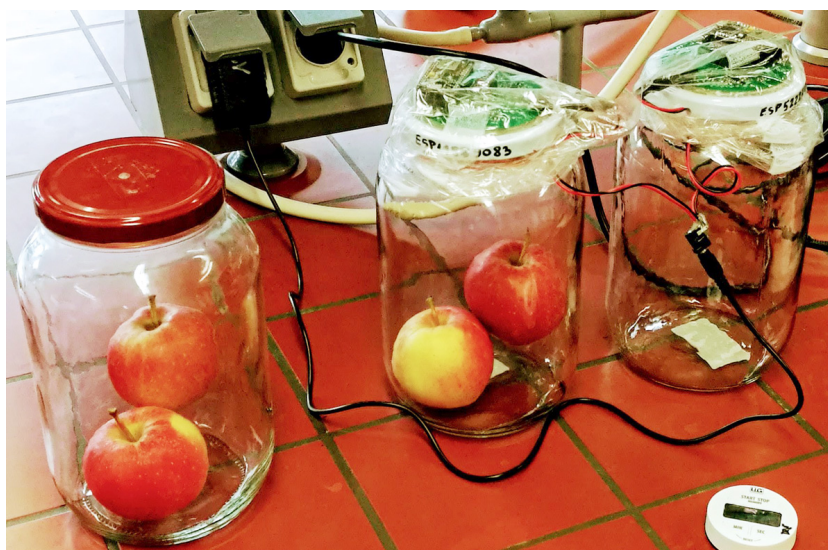
Slika 5.10: Spremljanje zorenja jabolk s senzorskim sistemom.
