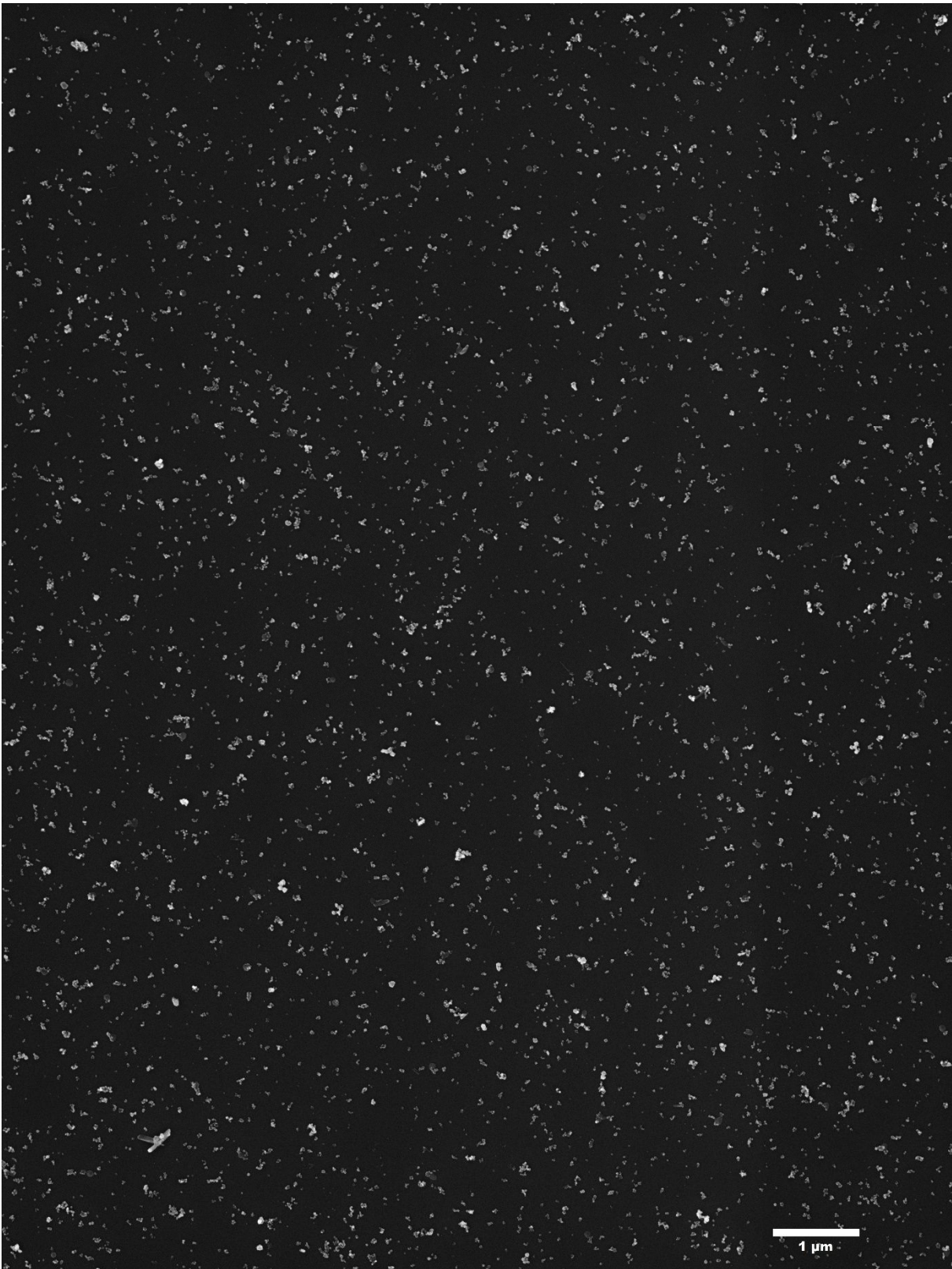
Abb. 10-18: Hochaufgelöste REM-Aufnahme Nr. 3 zur Bestimmung der Partikelgrößenverteilung von Magnetit synthetisiert bei 80 °C und 5,3 min Verweilzeit, Oxidationsmittel Chlorat. Aufnahmeparameter: 7500-fache Vergrößerung, InLens Detektor, 5kV Beschleunigungsspannung.
