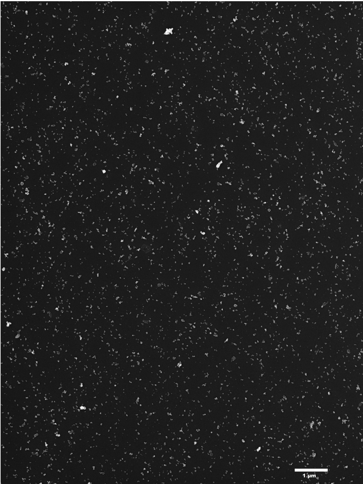
Abb. 10-20: Hochaufgelöste REM-Aufnahme Nr. 5 zur Bestimmung der Partikelgrößenverteilung von Magnetit synthetisiert bei 80 °C und 5,3 min Verweilzeit, Oxidationsmittel Chlorat. Aufnahmeparameter: 7500-fache Vergrößerung, InLens Detektor, 5kV Beschleunigungsspannung.
