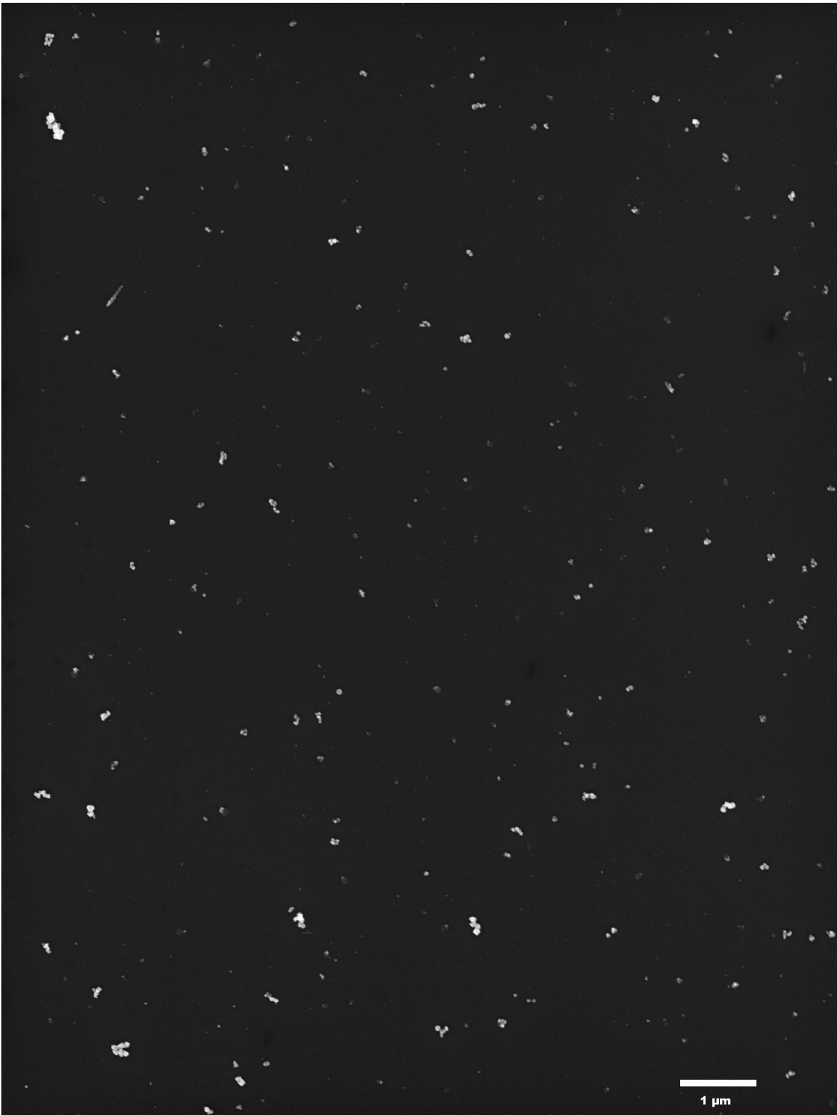
Abb. 10-2: Hochaufgelöste REM-Aufnahme Nr. 2 zur Bestimmung der Partikelgrößenverteilung von Magnetit synthetisiert bei 70 °C und 5,3 min Verweilzeit, Oxidationsmittel Nitrat. Aufnahmeparameter: 7500-fache Vergrößerung, InLens Detektor, 5kV Beschleunigungsspannung.
