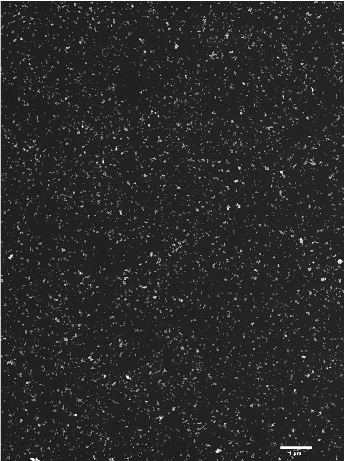
Abb. 10-14: Hochaufgelöste REM-Aufnahme Nr. 4 zur Bestimmung der Partikelgrößenverteilung von Magnetit synthetisiert bei 70 °C und 5,3 min Verweilzeit, Oxidationsmittel Chlorat. Aufnahmeparameter: 7500-fache Vergrößerung, InLens Detektor, 5kV Beschleunigungsspannung.
