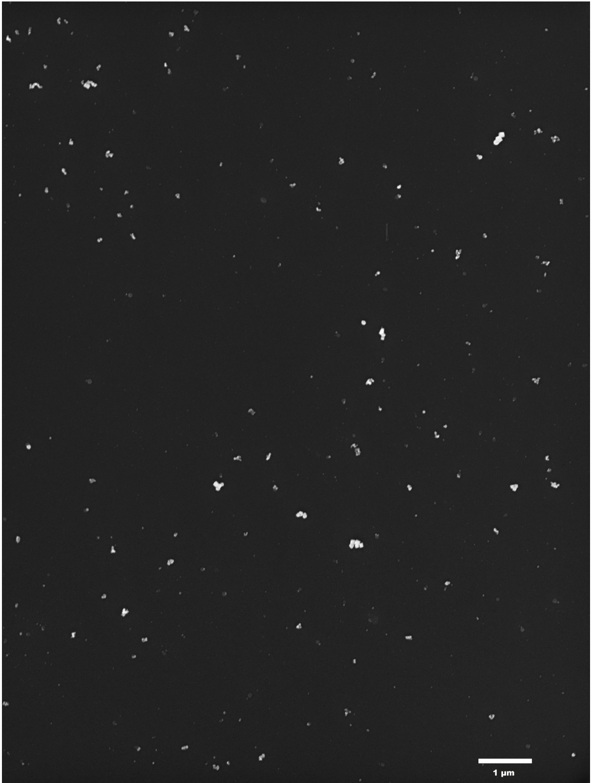
Abb. 10-1: Hochaufgelöste REM-Aufnahme Nr. 1 zur Bestimmung der Partikelgrößenverteilung von Magnetit synthetisiert bei 70 °C und 5,3 min Verweilzeit, Oxidationsmittel Nitrat. Aufnahmeparameter: 7500-fache Vergrößerung, InLens Detektor, 5kV Beschleunigungsspannung.
