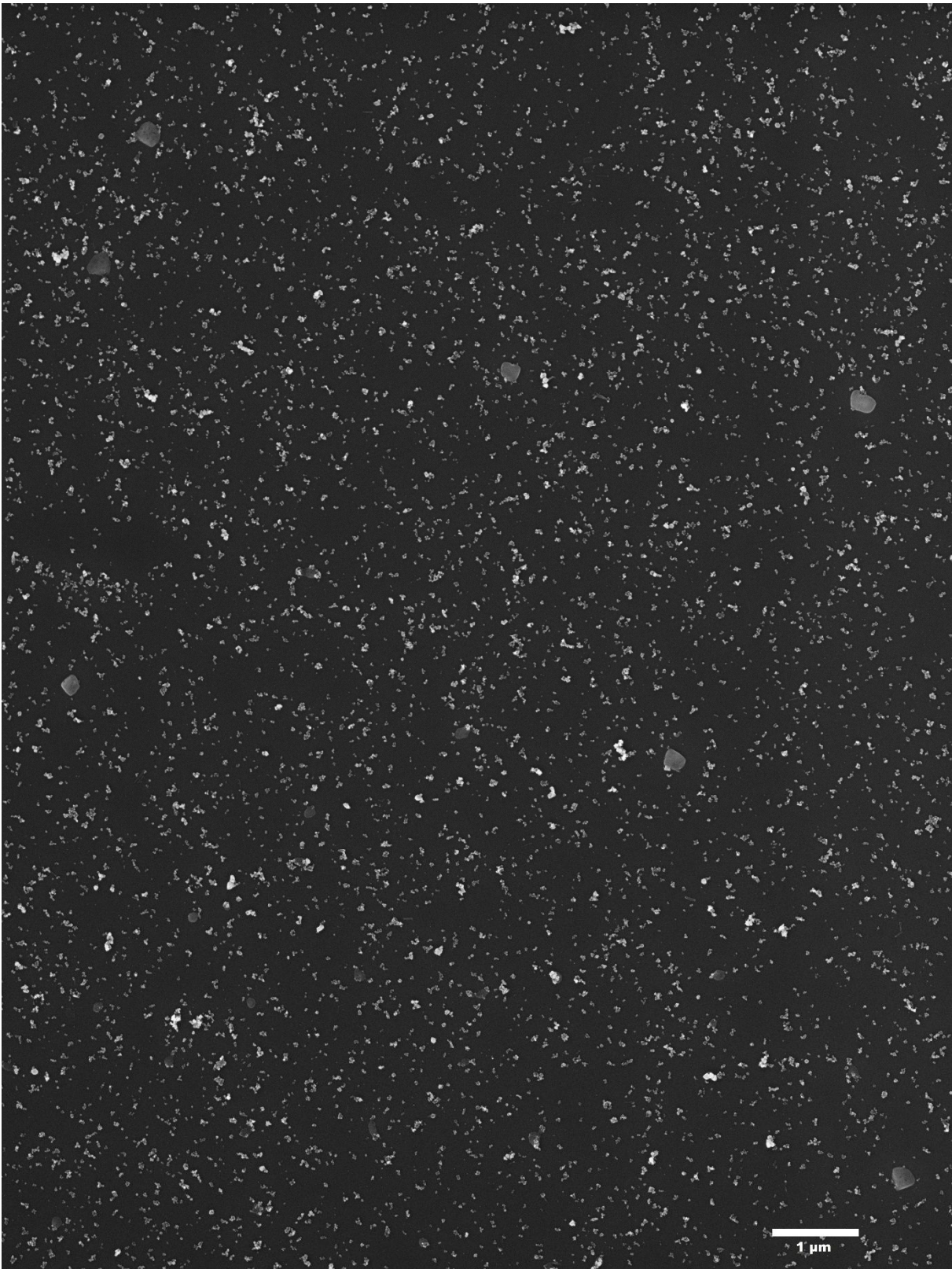
Abb. 10-16: Hochaufgelöste REM-Aufnahme Nr. 1 zur Bestimmung der Partikelgrößenverteilung von Magnetit synthetisiert bei 80 °C und 5,3 min Verweilzeit, Oxidationsmittel Chlorat. Aufnahmeparameter: 7500-fache Vergrößerung, InLens Detektor, 5kV Beschleunigungsspannung.
