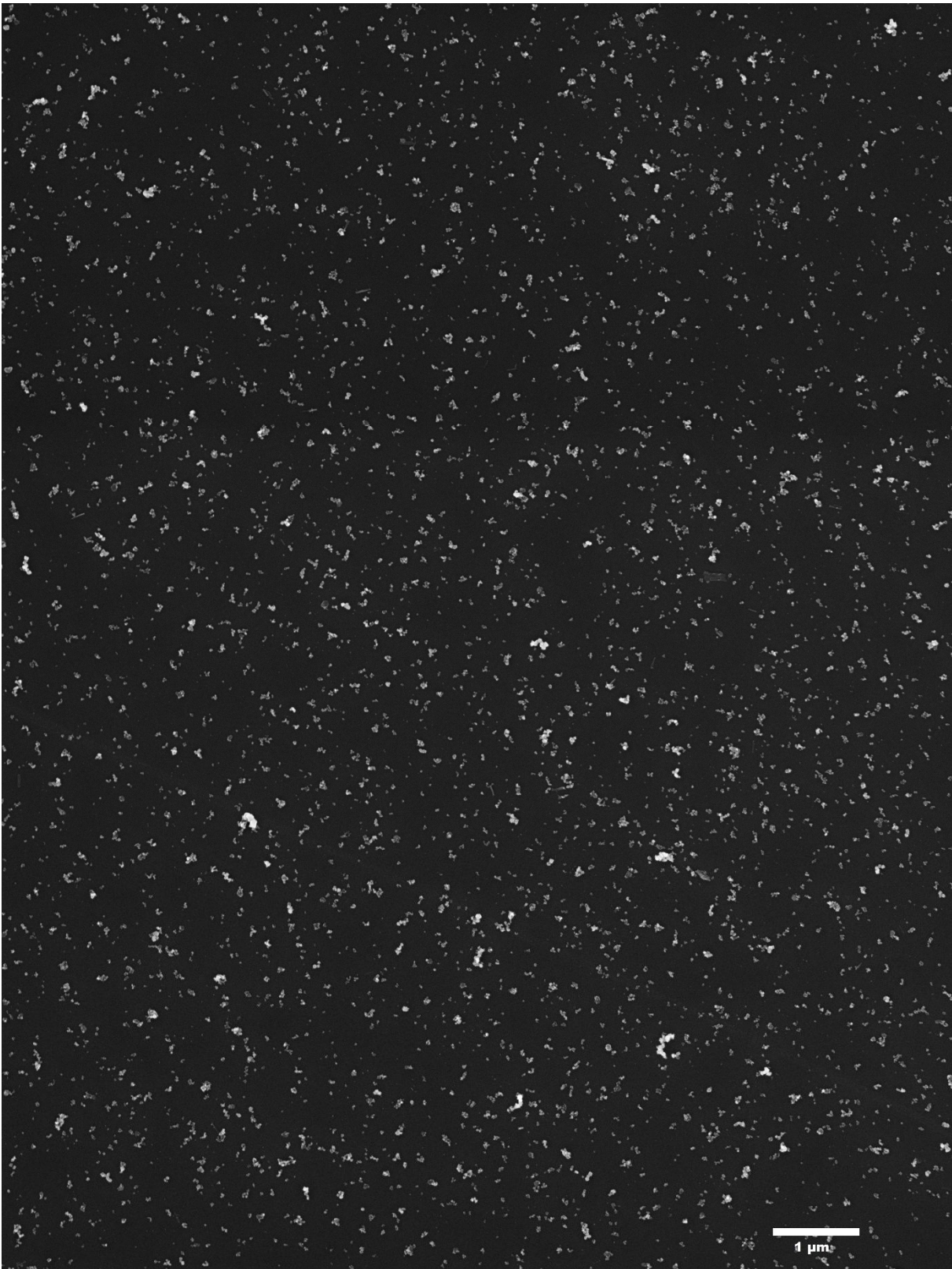
Abb. 10-12: Hochaufgelöste REM-Aufnahme Nr. 2 zur Bestimmung der Partikelgrößenverteilung von Magnetit synthetisiert bei 70 °C und 5,3 min Verweilzeit, Oxidationsmittel Chlorat. Aufnahmeparameter: 7500-fache Vergrößerung, InLens Detektor, 5kV Beschleunigungsspannung.
