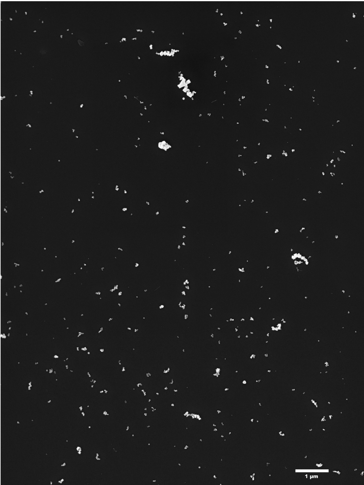
Abb. 10-6: Hochaufgelöste REM-Aufnahme Nr. 1 zur Bestimmung der Partikelgrößenverteilung von Magnetit synthetisiert bei 80 °C und 5,3 min Verweilzeit, Oxidationsmittel Nitrat. Aufnahmeparameter: 7500-fache Vergrößerung, InLens Detektor, 5kV Beschleunigungsspannung.
