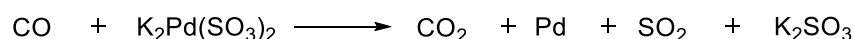
Schema 1-29: Reaktion von Kohlenmonoxid mit einem Palladiumkomplex zu CO 2 und elementarem schwarzen Palladium.
