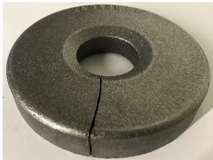
Abbildung 4-4 Rissprobe mit geschnittenem Riss
