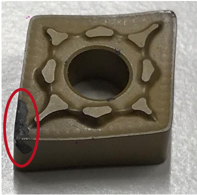
Abbildung 3-33 Ausbruch an Schneidkante mit roter Markierung
