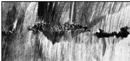
Abbildung 3-2 Links: Innenlunker, rechts: Innenlunker an einem Bauteil nach der Sichtbarmachung, Quelle: links: Hasse 2003, S. 181, rechts: Reuter und Schneider 1971, S. 139
