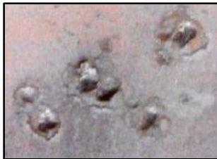
Abbildung 3-18 Kalteindrücke in einem Blech, Quelle: Verlag Stahleisen 2015, S. 48
