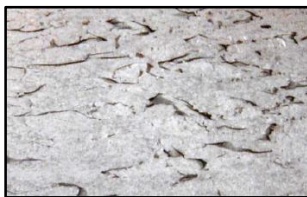
Abbildung 3-16 Z-Brüchigkeit an einem Blech, Quelle: Verlag Stahleisen 2015, S. 34
