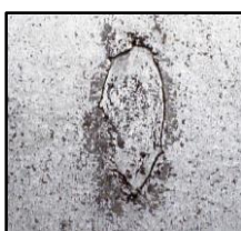
Abbildung 3-14 Schale in einem Blech, Quelle: Verlag Stahleisen 2015, S. 20
