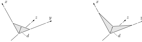
Abbildung 3.2: Von Leguillon (2014) berücksichtigte Rissformen. Bei gleicher Diagonalausdehnung d unterscheiden sich ihre Flächen um den Faktor zwei.
