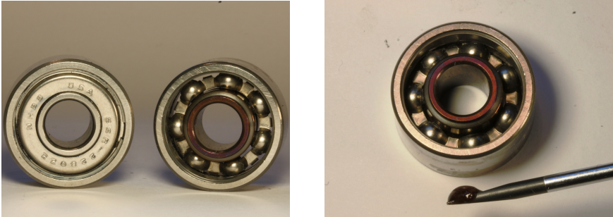
Abbildung 5.4.: Vorderes Lagerelement mit und ohne Abdichtung (links) sowie synthetische Diamantenpolierpaste für die Verunreinigung der Lager (rechts)
