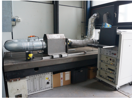
Abbildung 5.1.: Foto des verwendeten Axiallüfters (links) und Gesamtansicht der Testumgebung (rechts)
