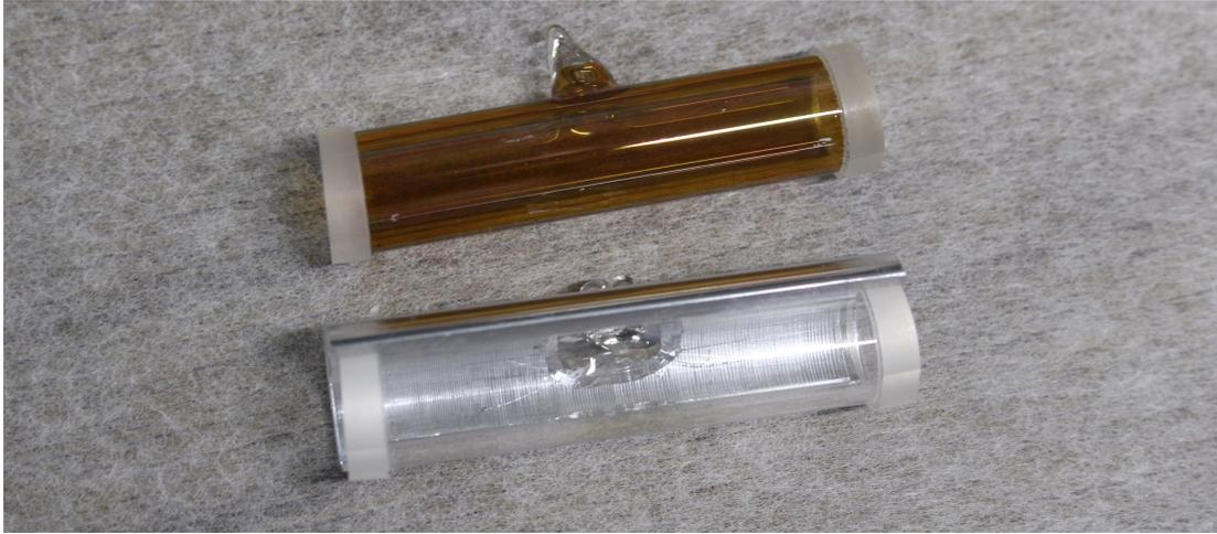
Abbildung 4.7: Defekte ESFADOF-Rubidiumgaszelle (oben) und Ersatzzelle aus dem Absorptionsfilter (unten). Man sieht deutlich die bräunliche Verfärbung der defekten Zelle.
