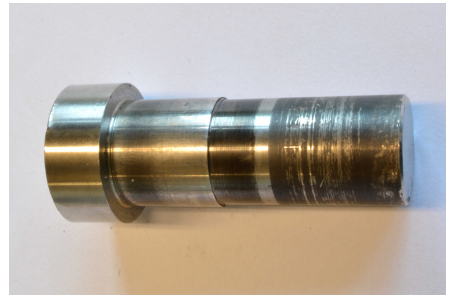
(d) Shaft corrosion
