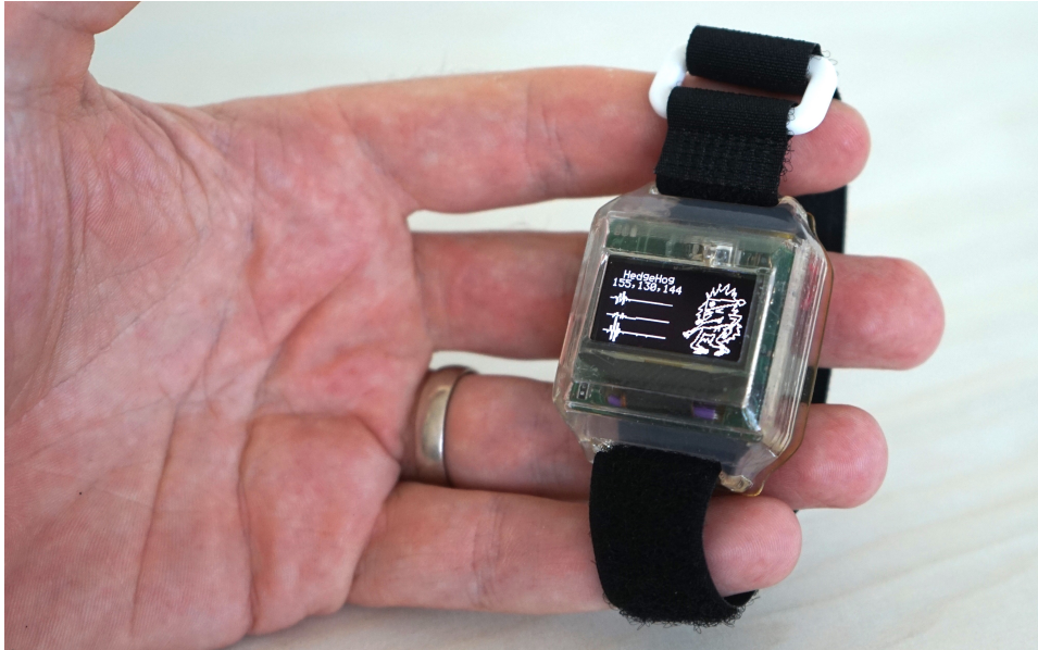
ABBILDUNG 5.1: Das Sensorsystem Hedgehog , das wie eine Armbanduhr am Handgelenk getragen werden kann. Es kann Beschleunigungsdaten mit einer Frequenz von bis zu 2 kHz aufzeichnen.
