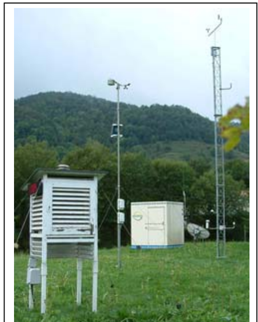
Estació meteorològica. S'aprecien dos anemòmetres a diferents altures, la torre que conté el termòmetre i al fons una estació automàtica. (Sant Pau de Segúries)
