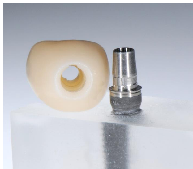
Abb. 4.8, Abb. 4.9: Prüfkörper aus eingebettetem Implantat und verschraubter Hybridkrone
