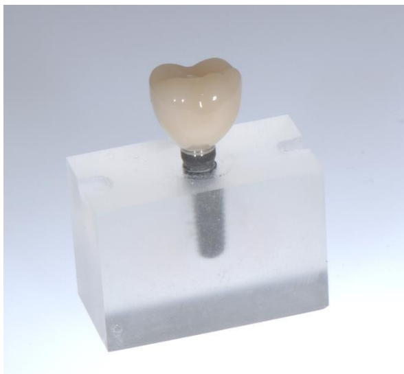
Abb. 4.8, Abb. 4.9: Prüfkörper aus eingebettetem Implantat und verschraubter Hybridkrone
