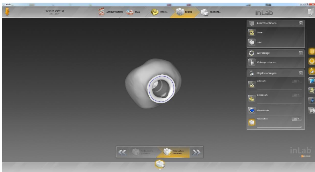
Abb. 4.5: Virtuelles Design der Anschlussgeometrie in der Software inLab SW 4
