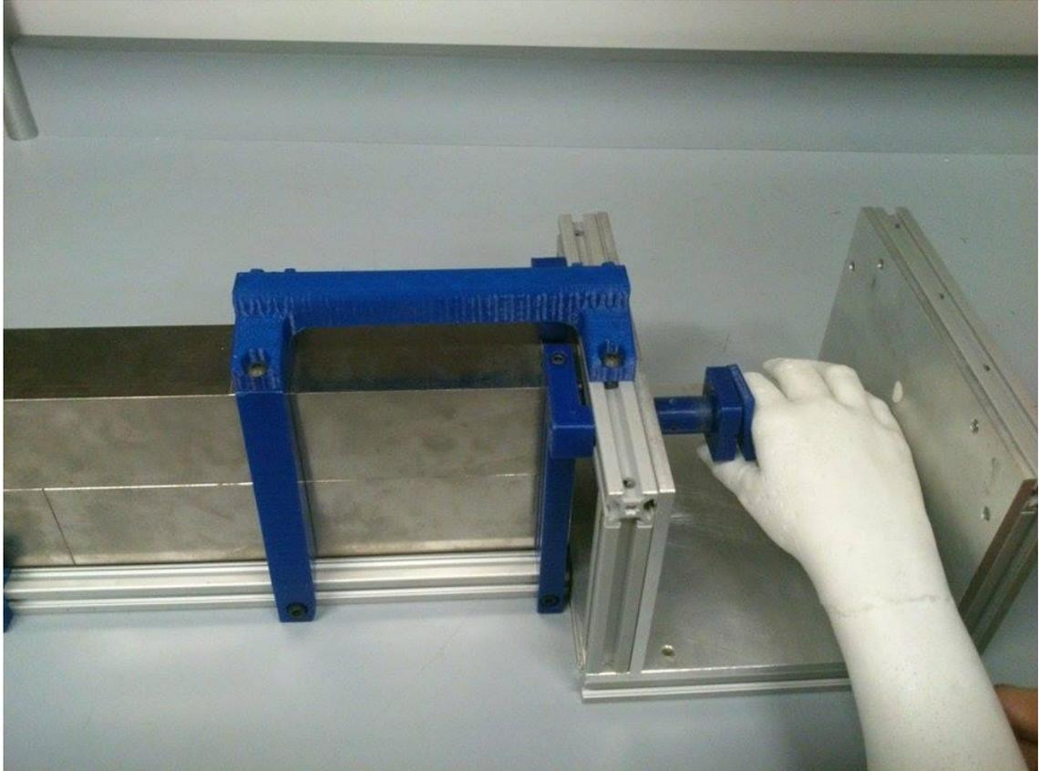
Figura 21. Mano con sensor dentro de compresor.
