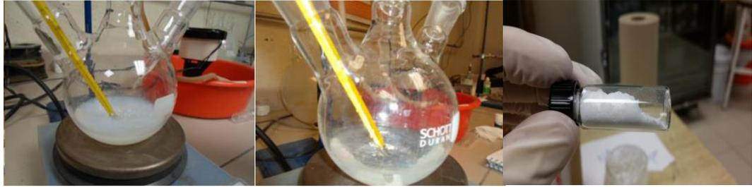
**Figura 23.** Las diferentes etapas del método de sol-gel durante la síntesis de nanopartículas base silicio a  $70\text{ }^\circ\text{C}$ .
