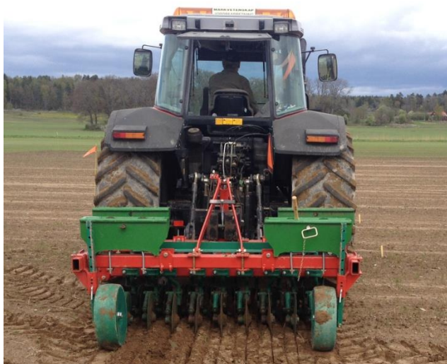
Figur 2. Vertikal rot/rhizom-skärare vid skärning innan sådd av samodlingsgrödor ("Oscar Prototyp" tillverkad av Kverneland ASA). Krusenberg, Uppsala 2014.
