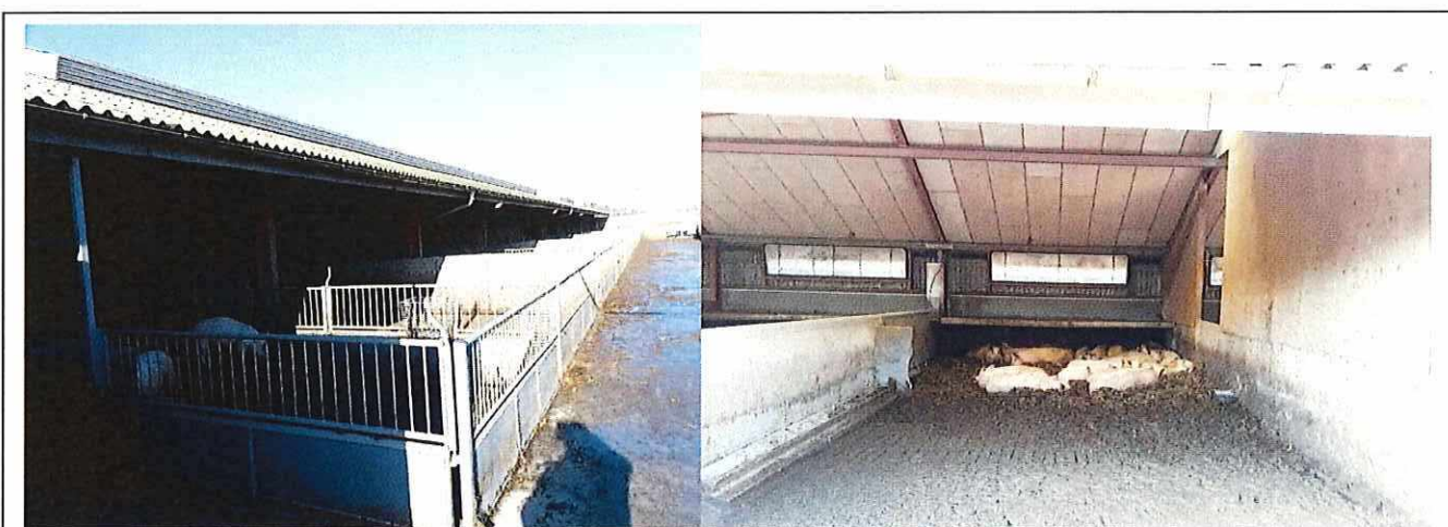
Figur 1. 'Helt åben': Helt åbent staldsystem med åben væg mellem ude- og indeareal. Lejeareal havde meget strøelse og var delvis overdækket. Gruppestørrelsen var 26 grise og der indgik 14 forskellige stier i undersøgelsen.
