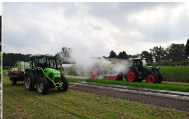
Abb. 14: CombiMIXER hinter Zugfahrzeug (rechts) und Wasserversorgungsfahrzeug (links) beim Einsatz in der Baumschule K, am 23.09.2016. Im Frontanbau des Versorgungsfahrzeugs ist die Zapfwellenpumpe zu erkennen. Der grüne Schlauch fördert Wasser aus dem Wasserbehälter, der rechte gelbe Schlauch leitet Wasser zum CombiMIXER, der linke dient als Bypass, der überschüssiges Wasser zurück in den Vorratsbehälter leitet
