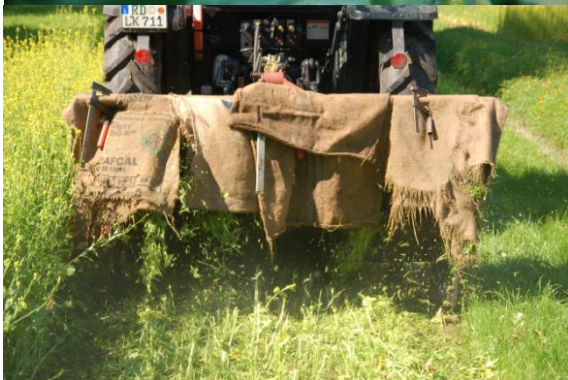
Abb. 5: Schlegelmulcher beim Mulchen von Sareptasenf im Rahmen einer Biofumigation
