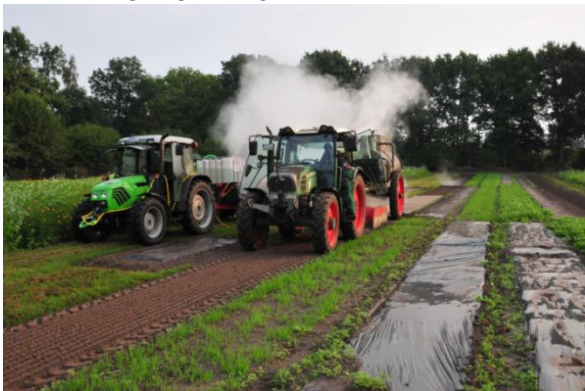
Abb. 13: CombiMIXER hinter Zugfahrzeug (rechts) und Wasserversorgungsfahrzeug (links) beim Einsatz in der Baumschule C, Holm am 23.09.2016
