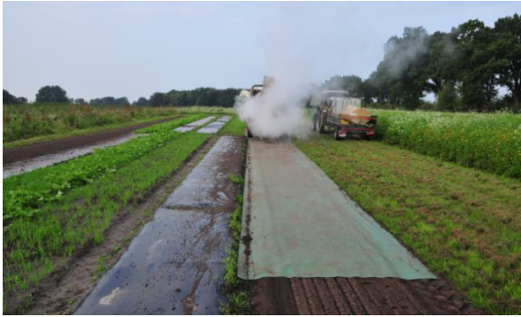
Abb. 15: Hinter dem CombiMIXER wird eine 10 m lange Schleppe aus grüner LKW-Plane über die gedämpfte Fläche gezogen, damit die Wärme möglichst lange im Boden verbleibt
