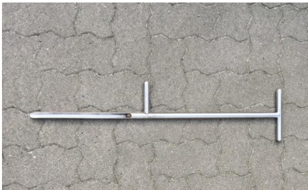
Abb. 20: Bohrstock (Länge 80 cm, Innendurchmesser 20 mm, effektive Beprobungstiefe 30 cm) aus Edelmetall mit Fußraste zur Entnahme von Bodenproben für die Analyse auf phytopathogene Nematoden oder verfügbare Nährstoffe
