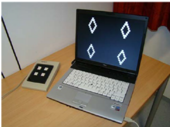
Abbildung 4: Bildschirmanzeige und Tastatur VigiMar (Cassel et al. 2011)
