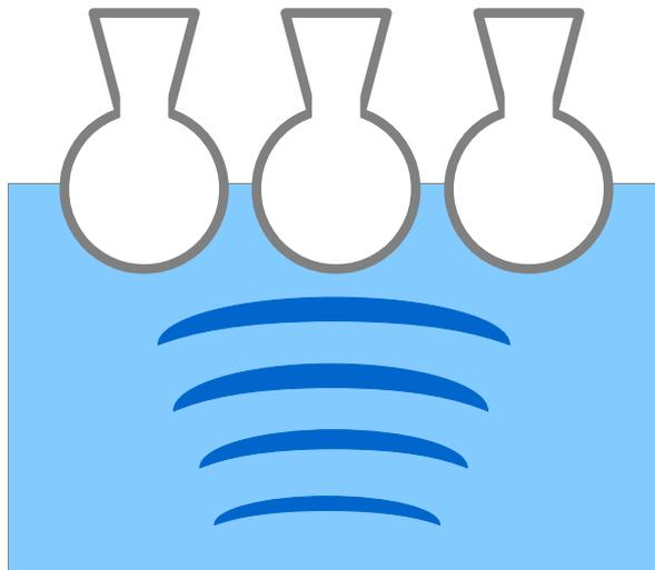
**Abbildung 18:** Schematische Darstellung der Untersuchung auf Einflüsse durch bestimmte Positionen im Ultraschallbad. Hierzu wurden die Glaskolben in einem Ständer eingespannt und gleichzeitig beschallt. Anschließend wurden sie auf Größe und Ultraschallkontrast vermessen und die erhaltenen Werte verglichen.
