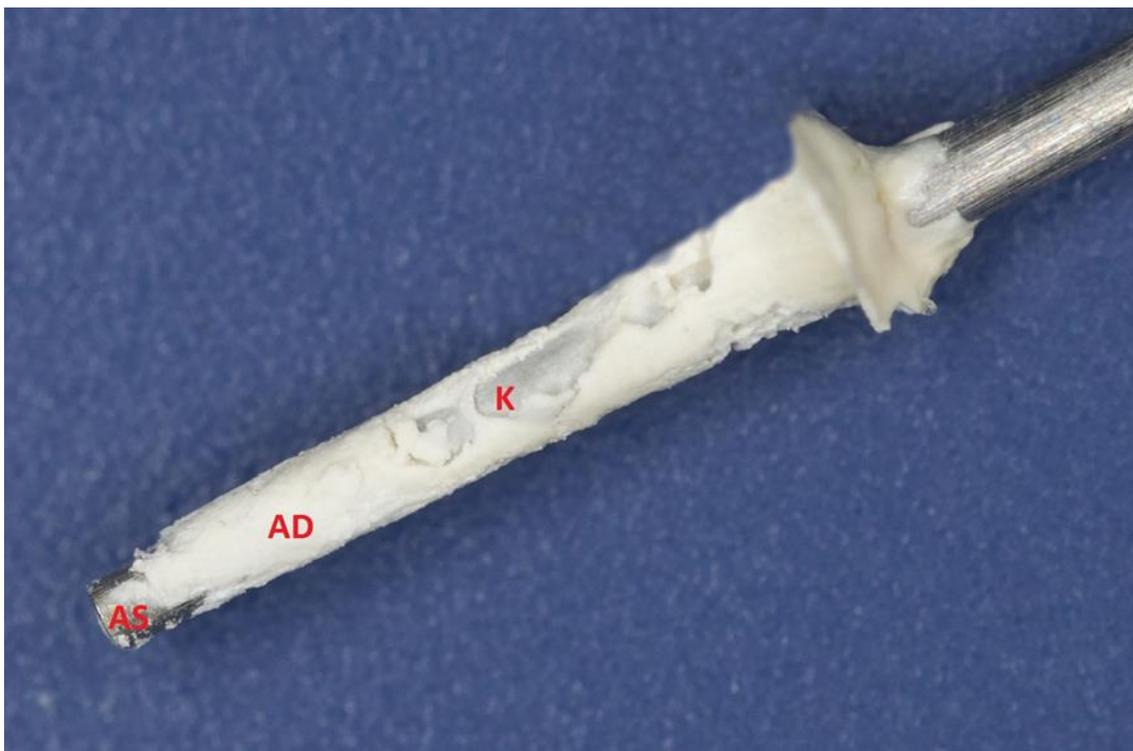
**Abb. 17:** Spreader mit gemischtem Frakturmodus (M)
