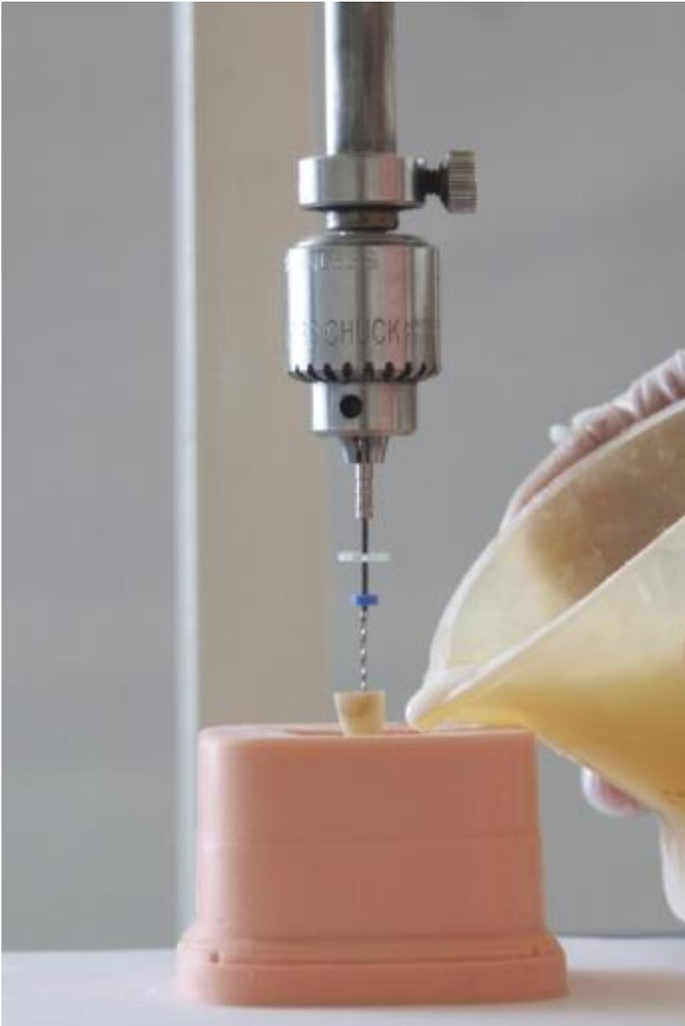
**Abb. 9:** Befüllen der Silikonform mit Kunststoff
