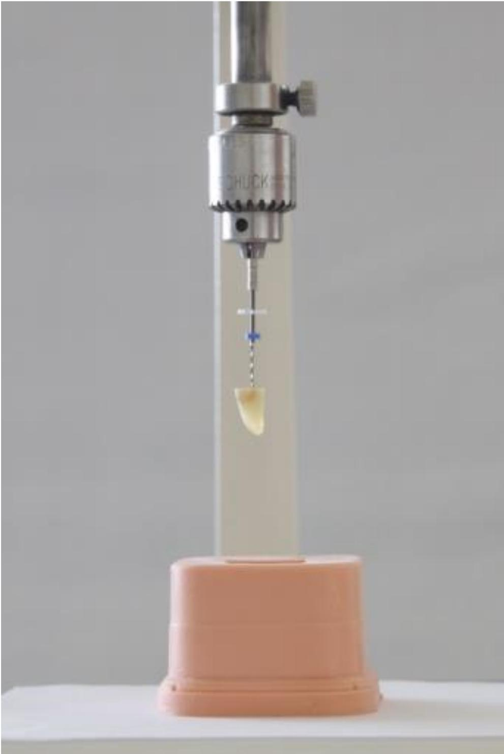
**Abb. 8:** Senkrechtes Ausrichten der Proben im Parallelometer
