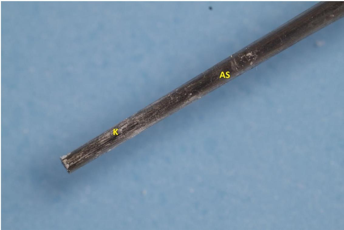
**Abb. 16:** Beispiel eines Spreaders mit der vorherrschenden Frakturmodi-Kombination: Verlust des Haftverbundes innerhalb der Sealerschicht (K) und zwischen Sealer und Spreader (AS)
