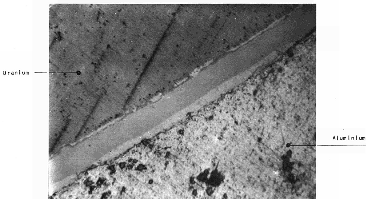
Fig. 20 - Echantillon UNA 11 - nickel 8 \mu - 3 \cdot 10^4 s à 520°C. (X 750)
