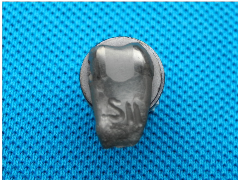
Abb. 8: Besputterte Probe mit rundem Kavitätenboden
