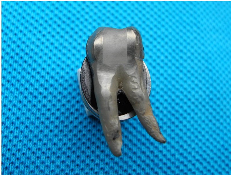
Abb. 9: Besputterte Probe mit eckig präpariertem Kavitätenboden
