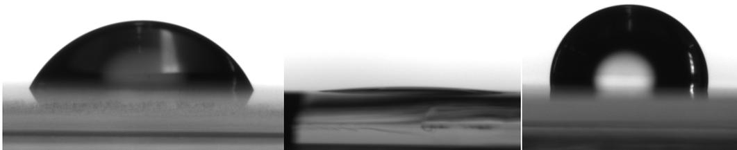
**Abb. 4.1: Tropfengestalt von Millipor-Wasser verschiedenen OF (Beispielbilder):** Links - nicht-„aktivierte“/nicht-silanisierte Glasoberfläche (Kontrollchip 1); Mitte – „aktivierte“/nicht-silanisierte Glasoberfläche (Kontrollchip 2); Rechts – OTS-silanisierte Glasoberfläche . Volumen 4 µl.
