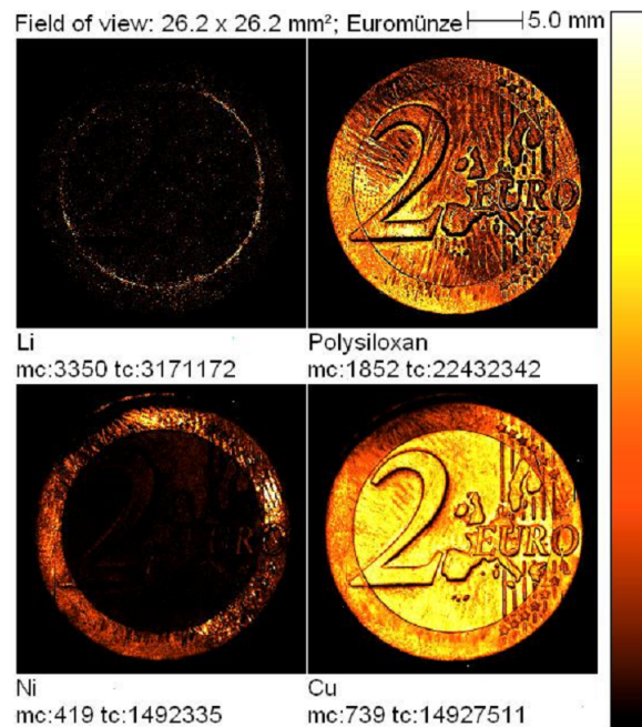
Abb. 3.11: Sekundärionenbild einer Münze für ausgewählte Elemente. Helle Bereiche entsprechen einer hohen Zählrate für das jeweilige Ion (mc: maximum ion count , tc: total ion count ). [73]
