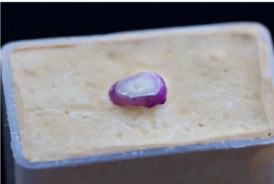
Abb. 6: Simuliertes Parodont mit Versuchszahn vor Beginn der Aufbereitung
