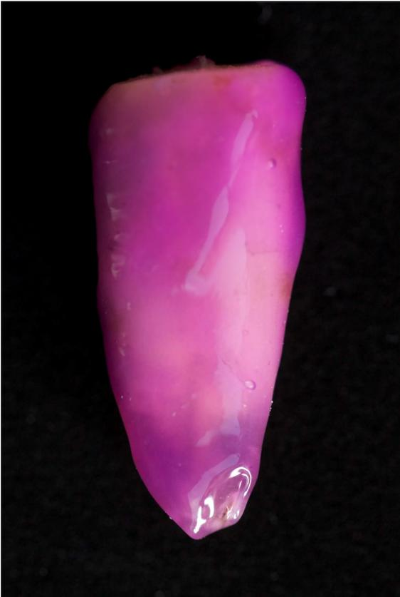
Abb. 5: Silikon-beschichteter Versuchszahn
