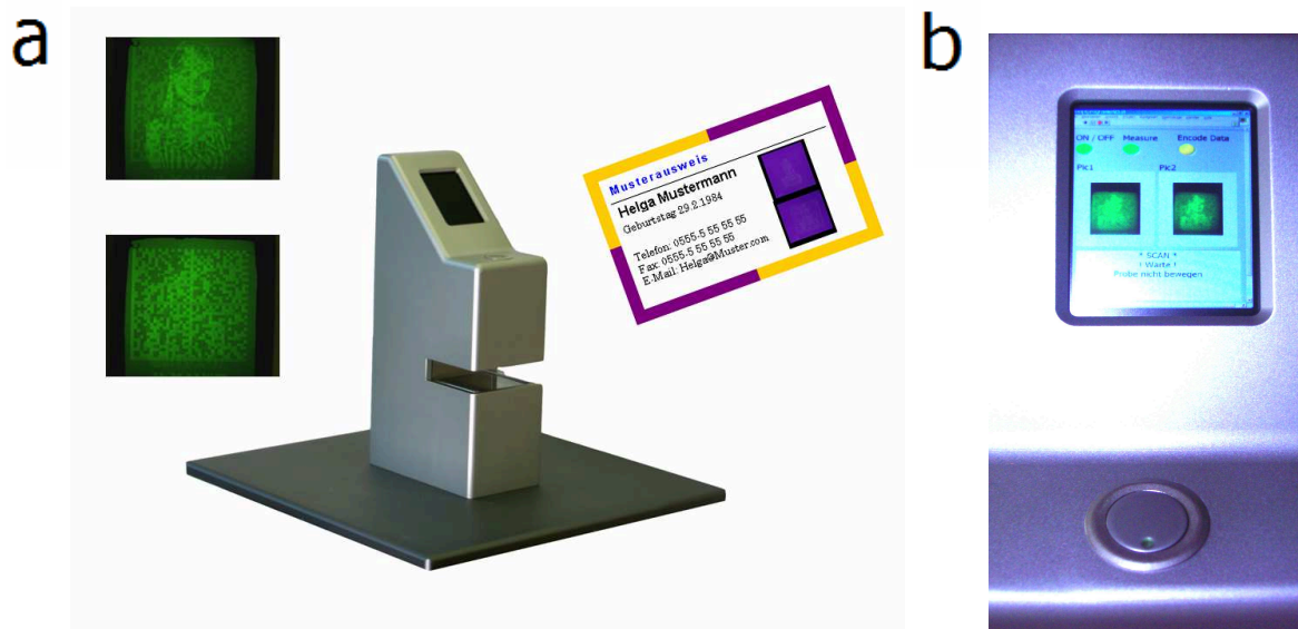
Abb. 74: (a) Polarisationsdatenlesegerät mit Ausweiskarte und ausgelesenen Polarisationsdaten in Form von zwei unterschiedlichen Bildern, einer Frau und einem Datamatrixcode. (b) Display und Bedienknopf.
