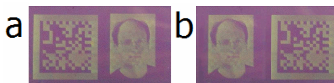
Abb. 63: Optische Datenspeicherung von zwei Informationen auf einer Stelle (links) Information A, (rechts) Information B in (a) ist das Leselicht parallel zu Information A in (b) senkrecht dazu. Somit erscheint die jeweils komplementär gespeicherte Information.
