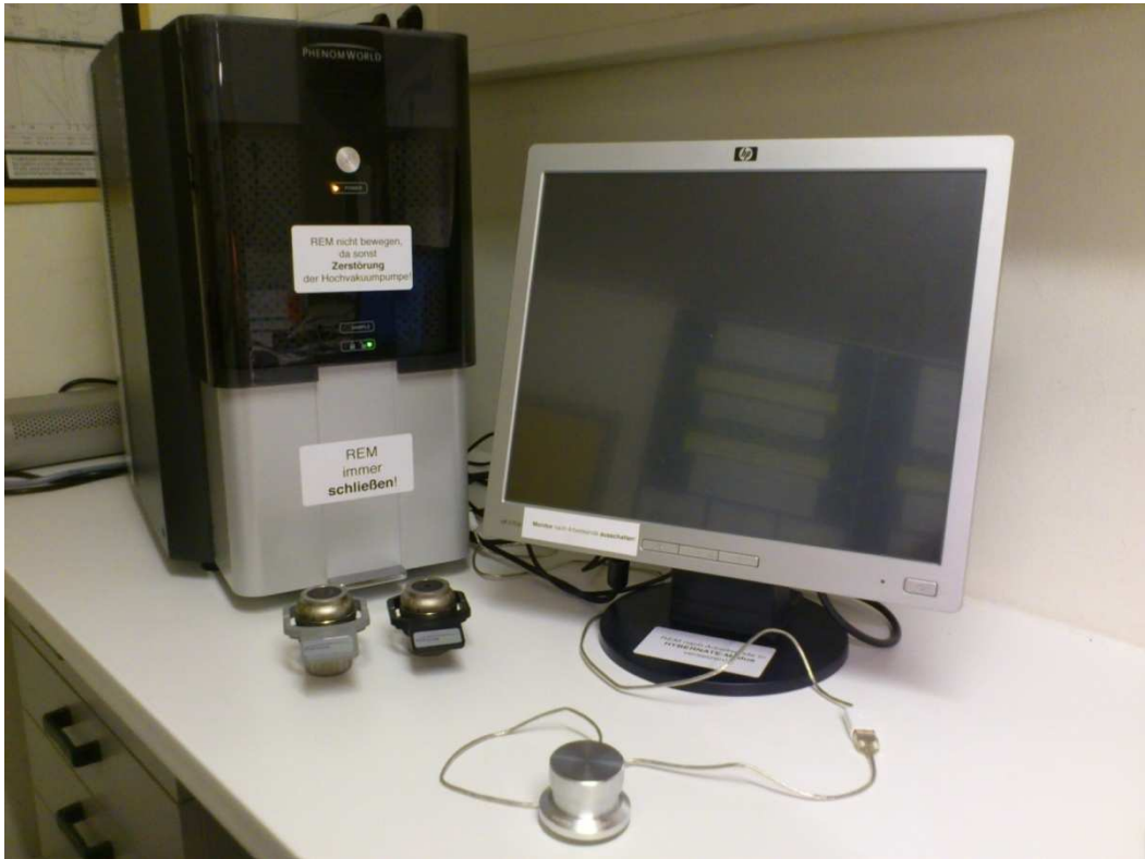
Abb. 6: REM Phenom, Phenom-World BV, Eindhoven, Niederlande
